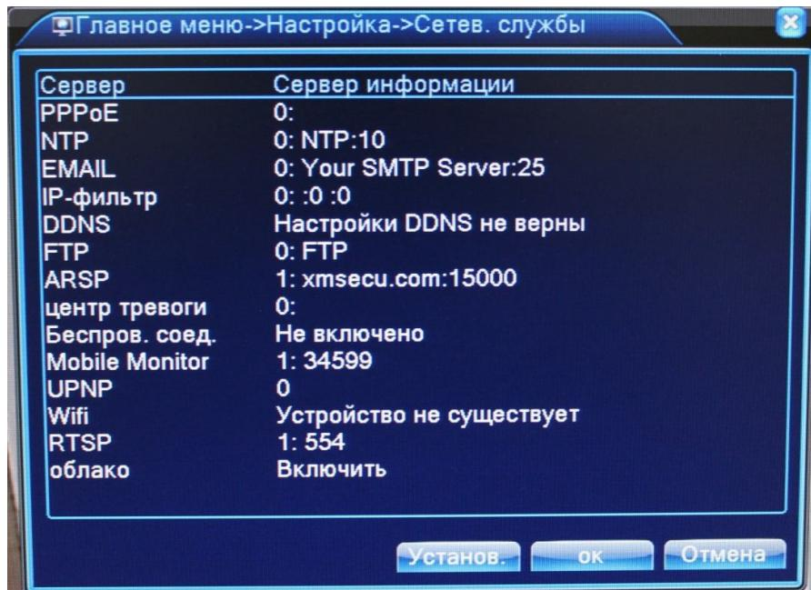
**PPPoE:** Настройка подключения через PPPoE. Требуется указать IP-адрес, пользователь и пароль
