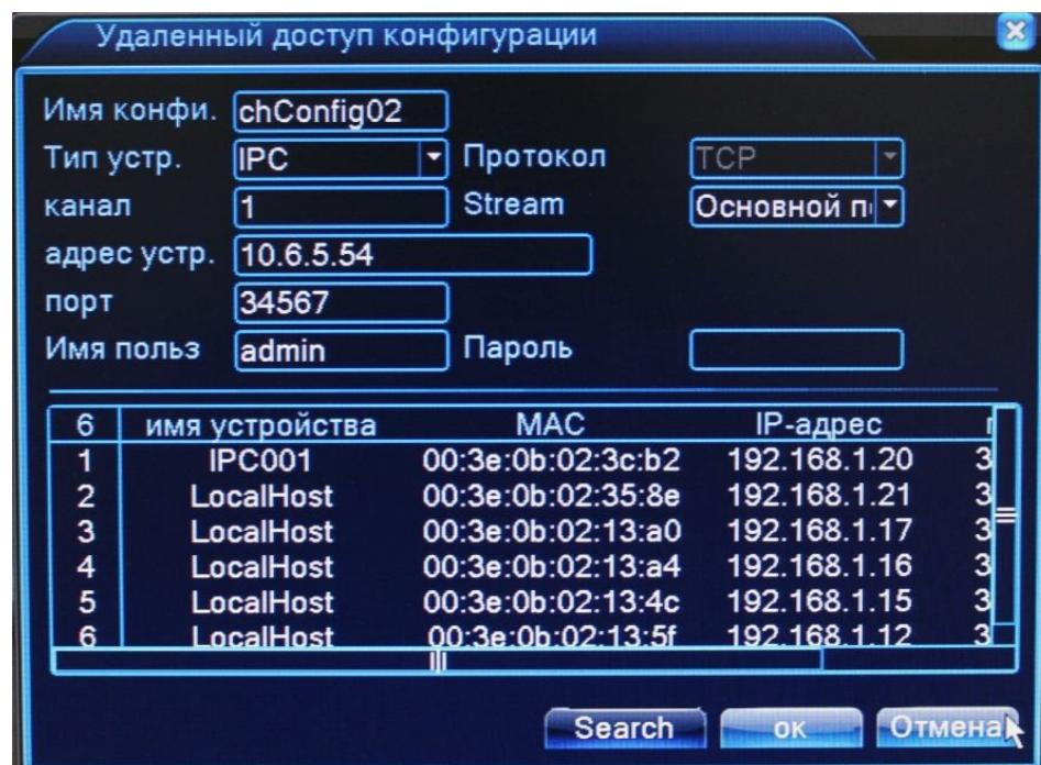
Для добавления устройства (конфигурации канала) на данный канал можно воспользоваться автоматическим поиском подключенных устройств (кнопка Search), либо, вписать настройки устройства вручную.
